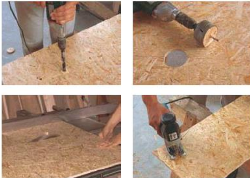
Рисунок 4. Механічна обробка плит OSB/3
